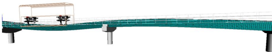
图 17 放大显示轨道梁变形
